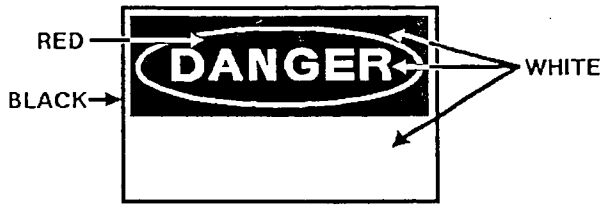
Fig. J-1 Danger Sign
